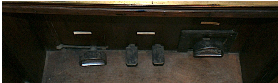
Figura 2. Basílica de Mafra, órgão do Evangelho | Pormenor dos pedais de anulação de cheios (esquerda) e de palhetas (direita).
